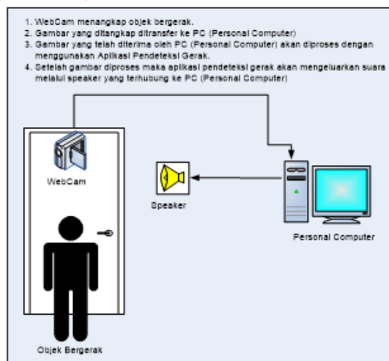
Gambar 1 Struktur Dasar Sistem keamanan Dengan Deteksi Gerak Menggunakan WebCam
